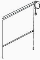
Toldo con cables guías
